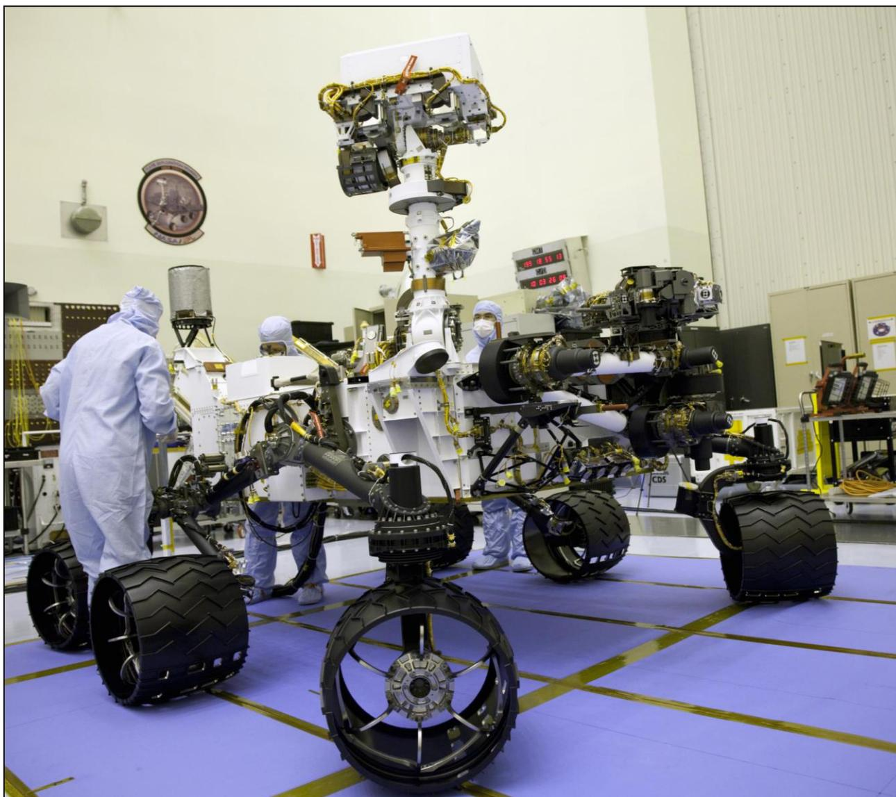
Está dotado un generador termoeléctrico de radioisótopos de tipo MMRTG (Multi-Mission Radioisotope Thermoelectric Generator) con 4,8 Kg de dióxido de Plutonio capaz de generar 2700 W/día de calor y 123 W de potencia eléctrica (con un voltaje de 28 V de corriente continua).
